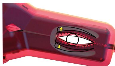
Pinza de Megger que se va a probar con labio de prueba estándar con certificación IEC para detectar fugas y holgura.
